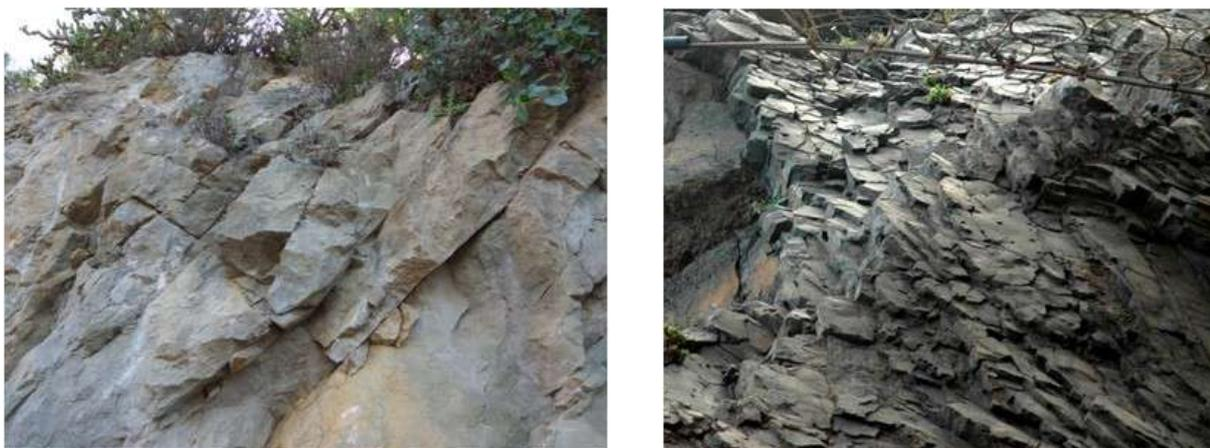
**Figura II.4.** Ejemplos de grados de fracturación. A la derecha macizo moderadamente fracturado, a la izquierda muy fracturado.
